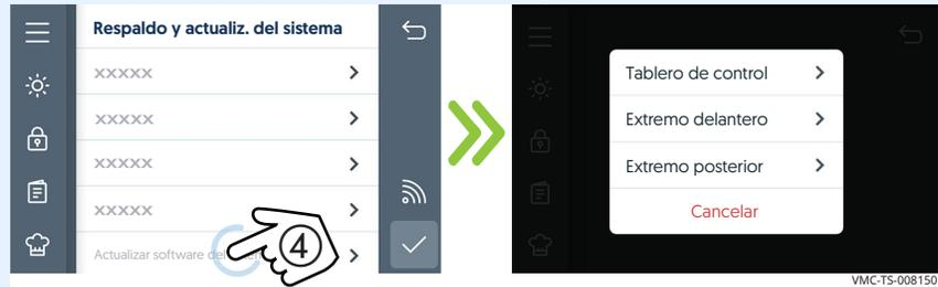
**Pulse** Panel de control (CB) para actualizar el panel de control. El horno cargará el software seleccionado. El horno comprobará el archivo y, a continuación, actualizará el CB.
