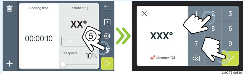
4. Ahora ajuste los parámetros de cocción. **Pulse** la temperatura de cocción ⑥. **Introduzca** la temperatura de cocción con el teclado. **Pulse** el tiempo de cocción ⑦. Introduzca el tiempo de cocción con el teclado. **Deslice** el control deslizante ⑧ para ajustar la velocidad del ventilador.
