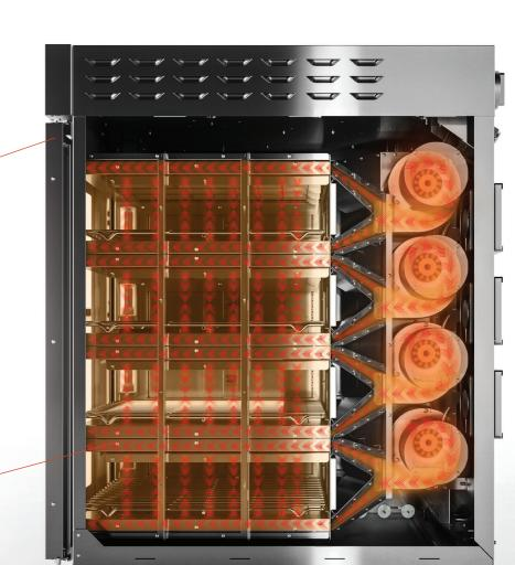
Cada cámara tiene su propia ruta de aire, fuente de calor y ventilador.
