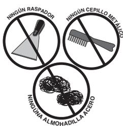
NOTA: Evite el uso de compuestos de limpieza abrasivos, limpiadores a base de cloruro o limpiadores que contengan sales cuaternarias. Nunca use ácido clorhídrico (ácido muriático) en acero inoxidable.
