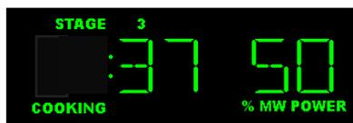
Esempio di display durante la cottura a livelli di potenza variabili.
